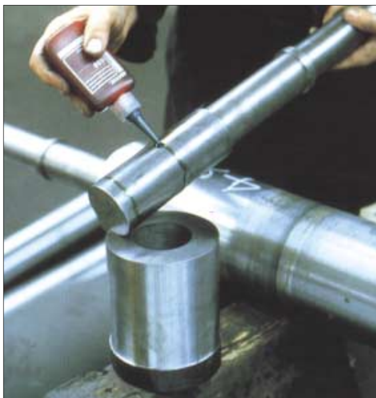
Клеевое соединение вала и цапфы ролика, которое экономит 1,5 часа времени на токарную обработку.
